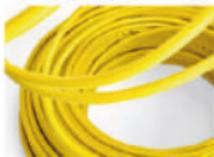
El tubo multicapa para el interior, normalmente, es de color amarillo. En ambos casos se puede pintar con pinturas acrílicas que no contengan disolventes, en caso de pintarse se tiene que marcar el tubo de manera que quede claro que es de gas, con sistemas permanentes e inequívocos (testigos de gas).
